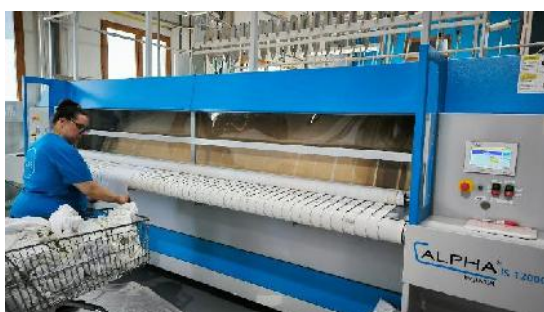
CALANDRA DE PLANCHADO DE GAS LAVANDERIA INDUSTRIAL (La Fresneda)
