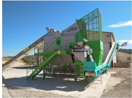
2019.10.2.034 PLANTA RECEPTORA DE OLIVA Y EVACUACION DE RESIDUOS
