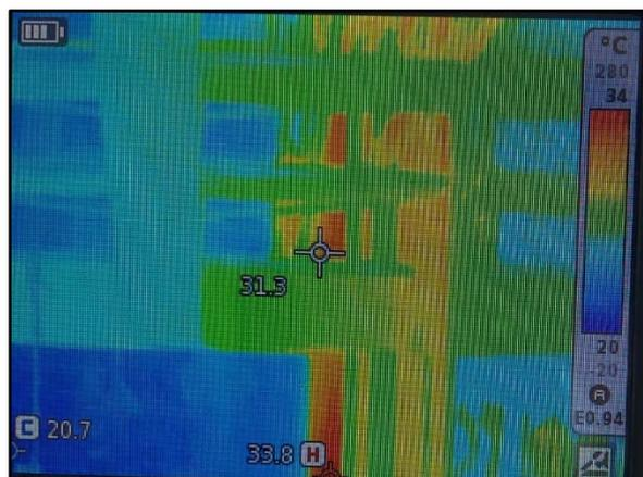
**Foto 4:** Imagen termográfica desde el interior del cerramiento de fachada totalmente acristalado.
