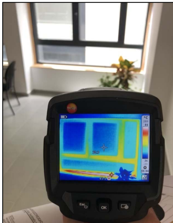
Imagen 10: Imagen termográfica donde se visualiza de una de las carpinterías de exterior existentes.
